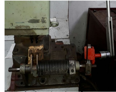
MCBG गवर्नर के लिंकेज के टार्सन स्प्रिंग का टार्क चेक करने हेतु टेस्ट स्टैण्ड
