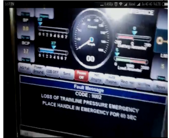
पेनाल्टी रिकवर न होने से पीसीएस ओपेन हो जाने की घटनाओं के विश्लेषण हेतु सिमुलेशन से तैयार किए गए वीडियो का एक दृश्य
