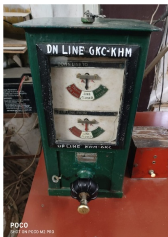
डबल लाईन ब्लॉक उपकरण
